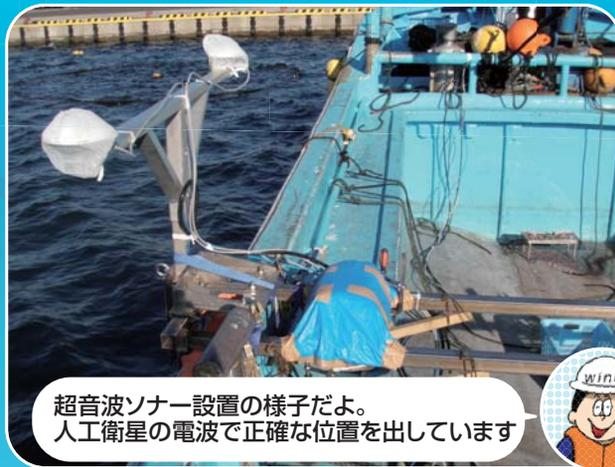
超音波ソナー設置の様子だよ。人工衛星の電波で正確な位置を出しています
